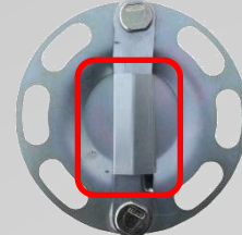
Positionner le clips de protection
